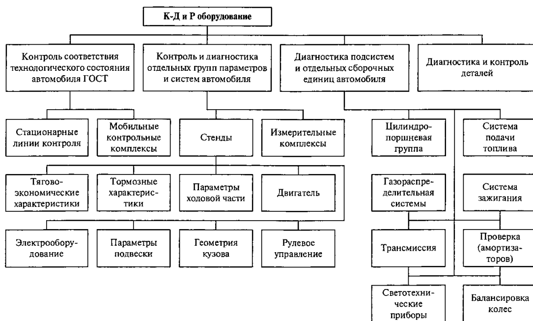
Рисунок 4.1 - Функционально-технологическая классификация контрольно-диагностического и регулировочного оборудования ПТС
