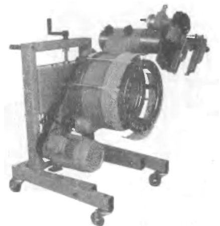
Рисунок 8.2 – Станок TD 502 для проточки тормозных дисков легковых автомобилей и барабанов колес мини-автобусов и мини-грузовиков без снятия их с автомобиля фирмы СОМЕС (Италия)
