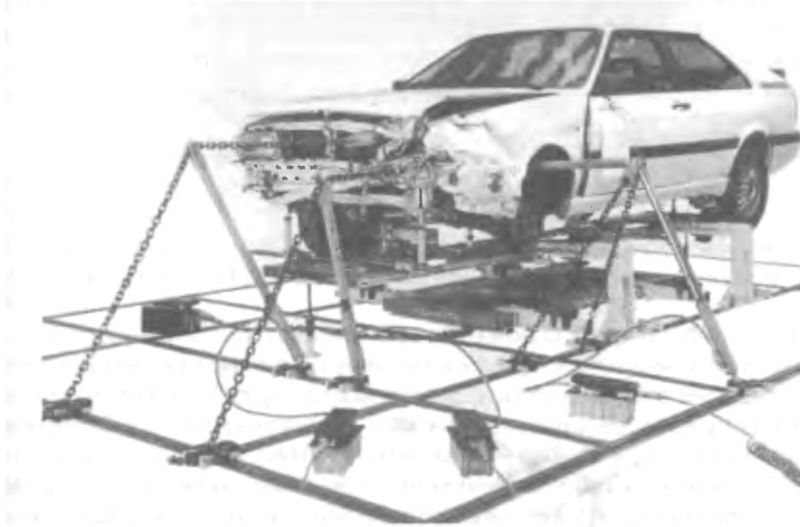
Рисунок 5.3 - Рамный стапель напольного исполнения для восстановления геометрии кузовов легковых автомобилей фирмы CELETTE (Франция)
