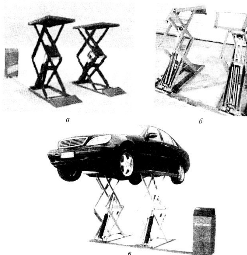
Рисунок 3.17 - Пантографные подъемники: а – TWIN F 3.0 A (в напольном исполнении), 3.0 U (в заглубленном исполнении) (МАНА - Германия); б - JUMBO LIFT IV (в заглубленном исполнении с электронно-гидравлической системой синхронизации подъема платформ) (NUSSBAUM -Германия); в - RAV5081 (с регулируемой длиной платформ для короткобазных и длиннобазных автомобилей) (RAVAGLIOLI - Италия)
