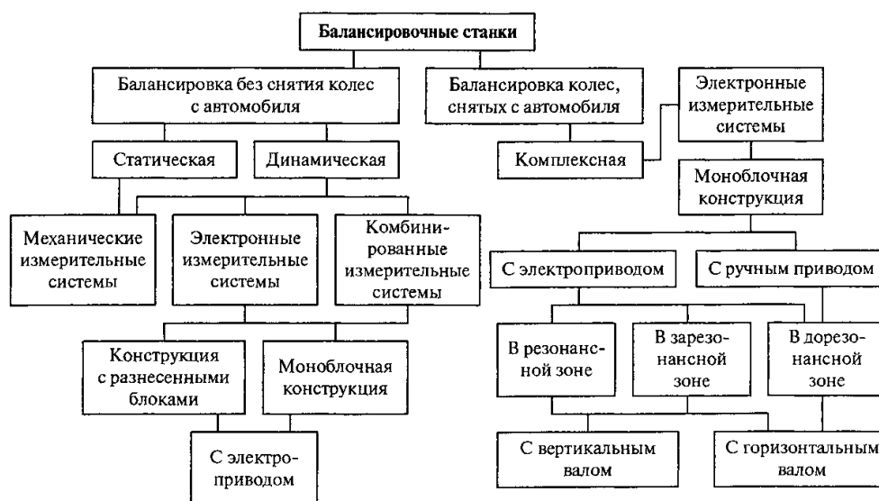
Рисунок 4.17 - Классификация станков для балансировки автомобильных колес
