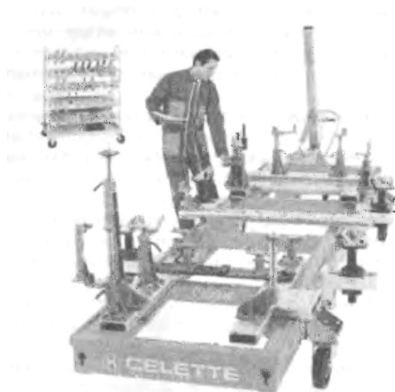
Рисунок 4.22 - Система шаблонов MZ для установки кузова на стапель SEVENNE фирмы SELETTE (Франция)
