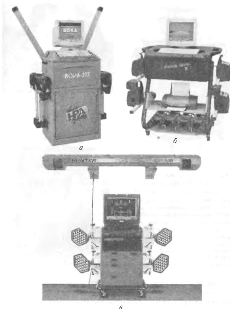
Рисунок 4.11 - Беспроводные стенды для контроля и регулировки углов установки колес: а — BORA 217 фирмы HPA (Германия) — полностью инфракрасный стенд, выполненный по формуле 8x4 с образованием замкнутого измерительного контура; б — RAVTD 5060 фирмы RAVAGLIOLI (Италия) — полностью инфракрасный стенд,
