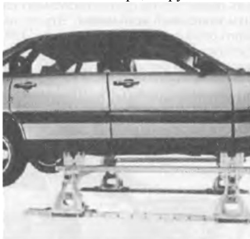
Рисунок 5.4 - Анкерный стапель CHAINLESS для проведения краткосрочного кузовного ремонта фирмы WEDGE CLAMP SYSTEM (Канада)
