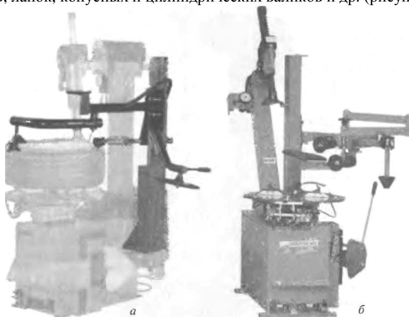
Рисунок 6.6 - Пневматическое устройство типа «третья рука» для монтажа — демонтажа колес легковых автомобилей с низкопрофильными шинами: а — МН 310 — предназначенное для установки на полуавтоматические шиномонтажные станки моделей SWING фирмы Snap on Equipment (Англия); б — GR 81 — предназначенное для
